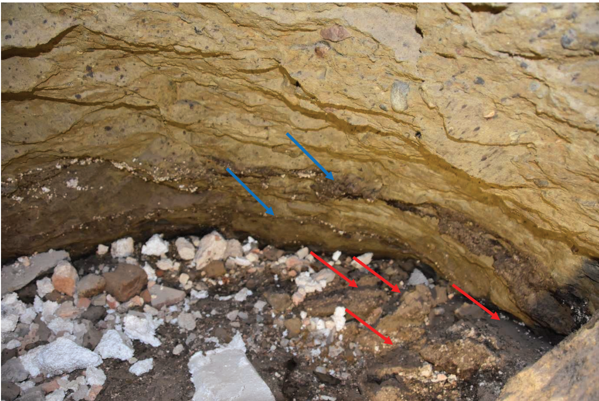
Fot. 23 Komora zapadliska. Na powierzchni gruntu przesklepienia komory w dolnej części ciemne linie z przywartymi granulkami styropianu - śladami chwilowego stagnowania w zapadlisku wody ze zniszczonych instalacji bezpośrednio pod katastrofą. zalegające fragmenty betonu, styropianu, cegły. W dnie komory ślady odpływu wody w kierunku północno-zachodnim. Stan na dzień 2.02.20019 r.
